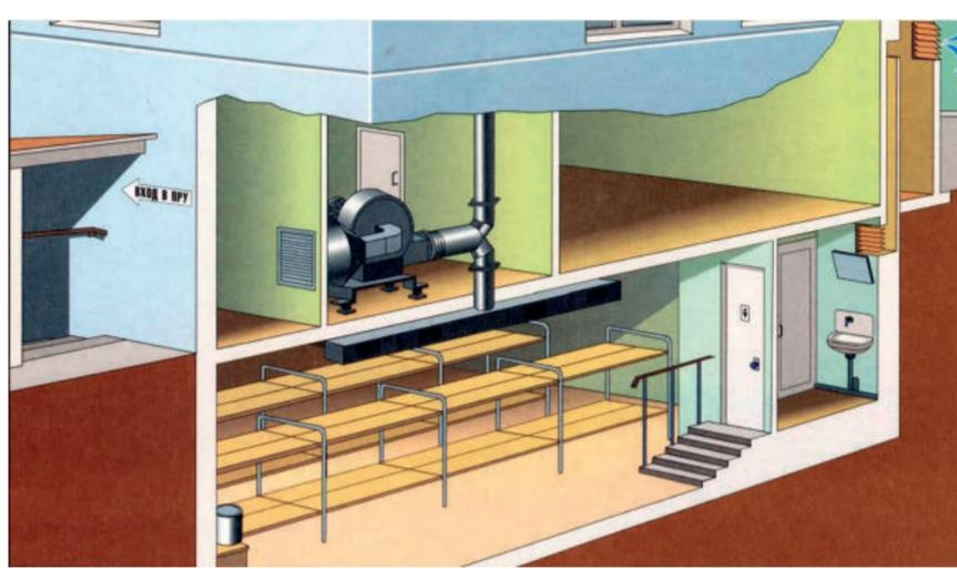
**Противорадиационное укрытие** — защитное сооружение гражданской обороны, предназначенное для защиты укрываемых от воздействия ионизирующих излучений при радиоактивном заражении (загрязнении) местности и допускающее непрерывное пребывание в нем укрываемых в течение нормативного времени.
